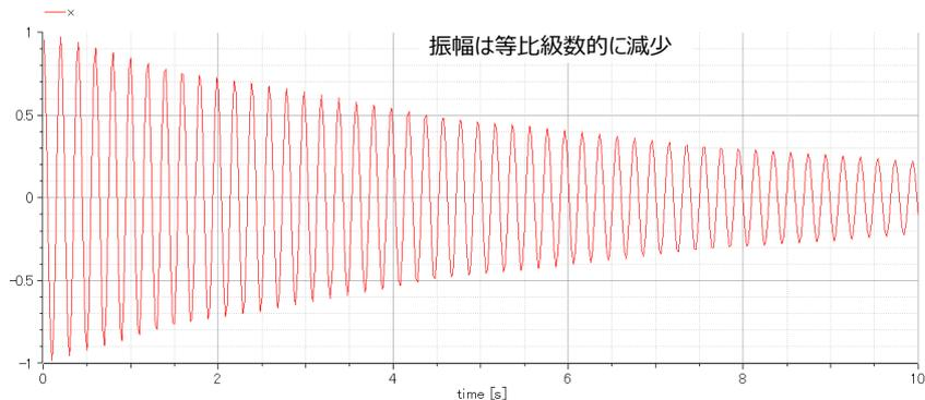
図 4 粘性減衰、ヒステリシス減衰の場合の減衰波形
