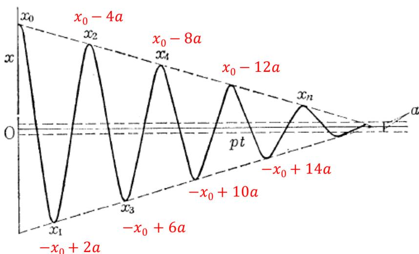
図 5 摩擦減衰の減衰波形の理論解
