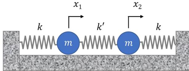
図1 二自由度系のばね・マスモデル
